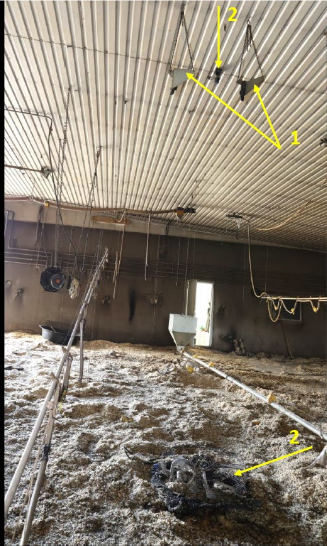
Fig. 12: Viser området hvor vifta var montert, jf. fig. 11. Pilene 1 viser festeanordningen i taket. Pil 2 viser vifta E-1 på gulvet. Pil 3 viser stikkontakten i taket, hvor støpselet til vifta hadde vært tilkoblet.
